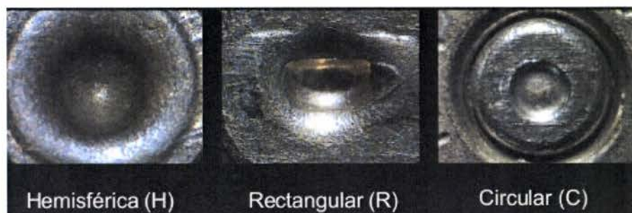
Ejemplos de huellas producidas por el percutor en cartuchos de fuego central
